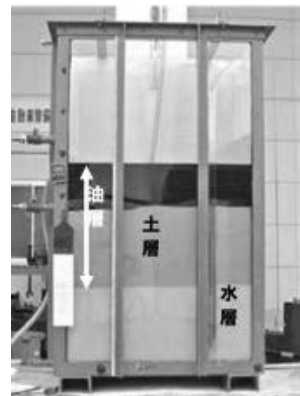
図-3 大型土槽外観（吸引前）
