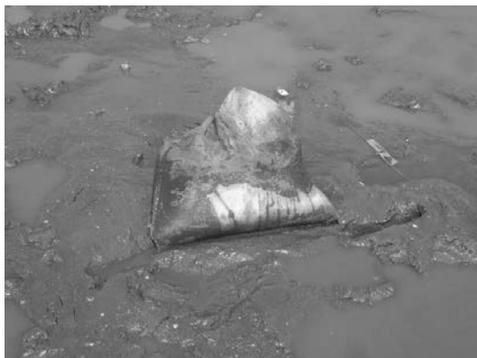
写真-1 フルボ酸鉄シリカ資材（外側の袋の素材は生分解性：おおよそ2年程度で分解される）
