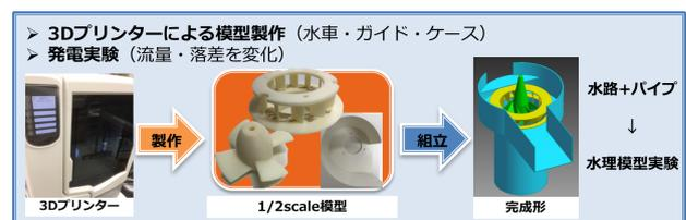
図-4 縦軸型水車の模型製作と水理模型実験
