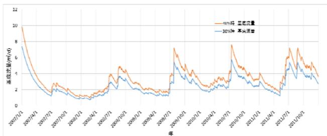
図-9 浸透域変化による基底流量変動
