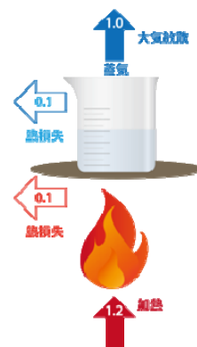
図-3 一般的な蒸発工程の熱収支
