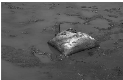
写真-1 干潟に設置したフルボ酸鉄シリカ資材
