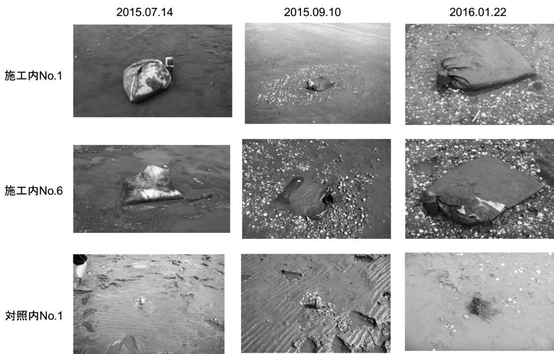
写真-5 2015年7月14日（フルボ酸鉄シリカ資材設置）以降の施工区内と対照区内の干潟表面の比較
