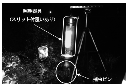
写真2 燈火採集調査機材（水銀灯 標準の照度）
