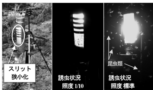
写真3 照度1/10の燈火採集調査機材と誘虫状況
