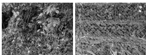
土壌厚 1cm, 水分量 83.4% 日射量 0.25kwh/m 2 /day 土壌厚 0cm, 水分量 19.6% 日射量 0.45kwh/m 2 /day
