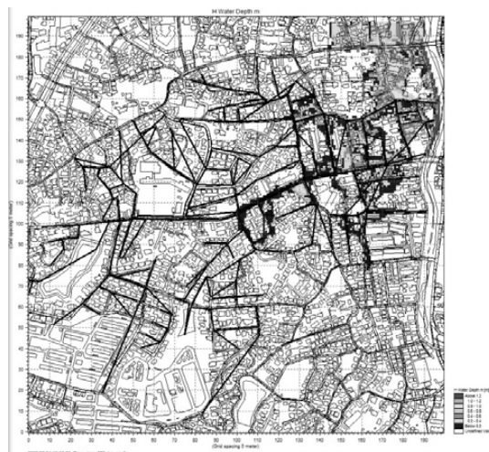
図-10(1) 流出抑制前の氾濫状況
