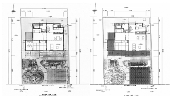
図-1 雨水利用住宅貯水槽配置図
