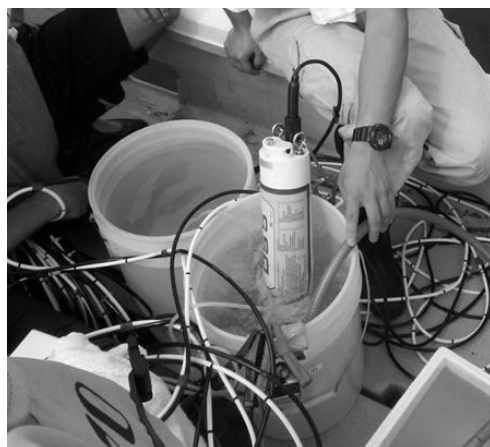
写真-3 現地で採取した海水の酸素消費速度測定
