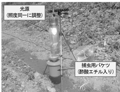
写真-3 燈火採集調査用の機材
