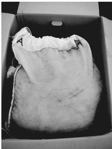
写真-4 設置用フルボ酸鉄資材（生分解性袋入り）
