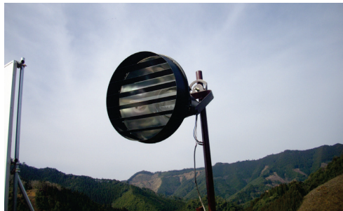
写真-4 ルーバーの設置例
