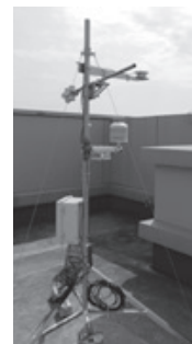
図-2 屋上に設置した気象観測システム
