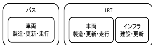
図-1 LCAのシステム境界
