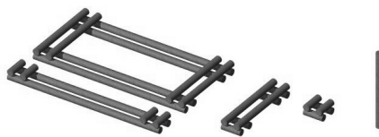
図-4 間伐材二重井桁枠工部材図
