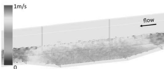
図-9 流速ベクトルの縦断方向（ワンド部・凹部あり）
