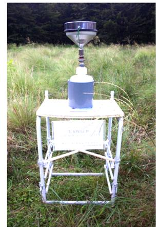
写真-1 雨水採取装置 (B地点)
