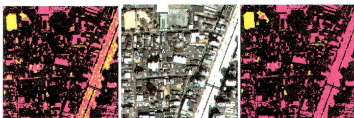
図 3.7 コンクリート、土壌（黄土色）の抽出結果
