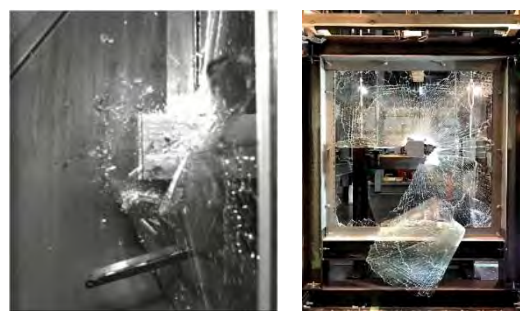
図-5 フィルムを二枚分割して貼付した板ガラスの 衝突実験における破壊挙動
