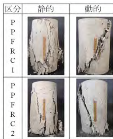
図-9 圧縮実験の破壊性状
