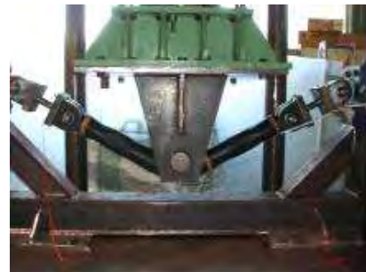
図-3 静的曲げ実験の模式図
