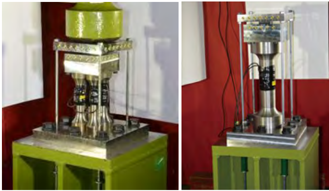
(a) 90kN 級ロードセル (b) 490kN 級ロードセル 写真-2 衝撃载荷実験装置の状況
