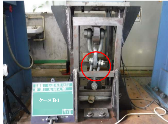
写真-3 供試体の傾き
