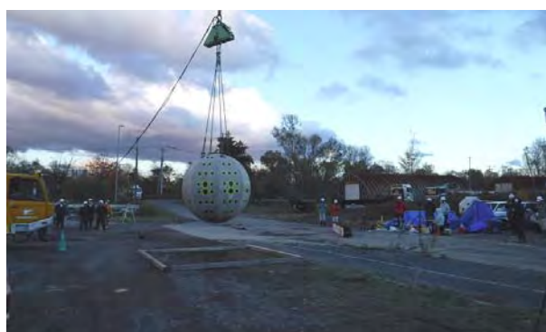
写真二 実験状況 (土砂地盤, 模擬球体 8.3t)
