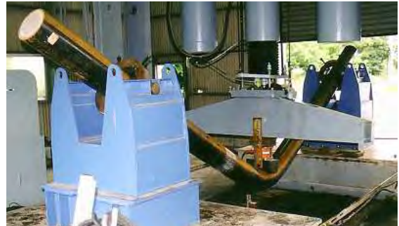
図-7 支柱曲げ実験
