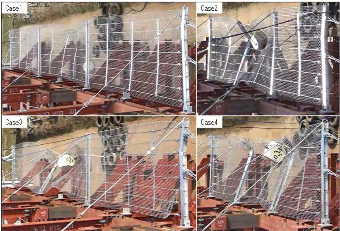
写真一五 重錘衝突後の供試体損傷状況
