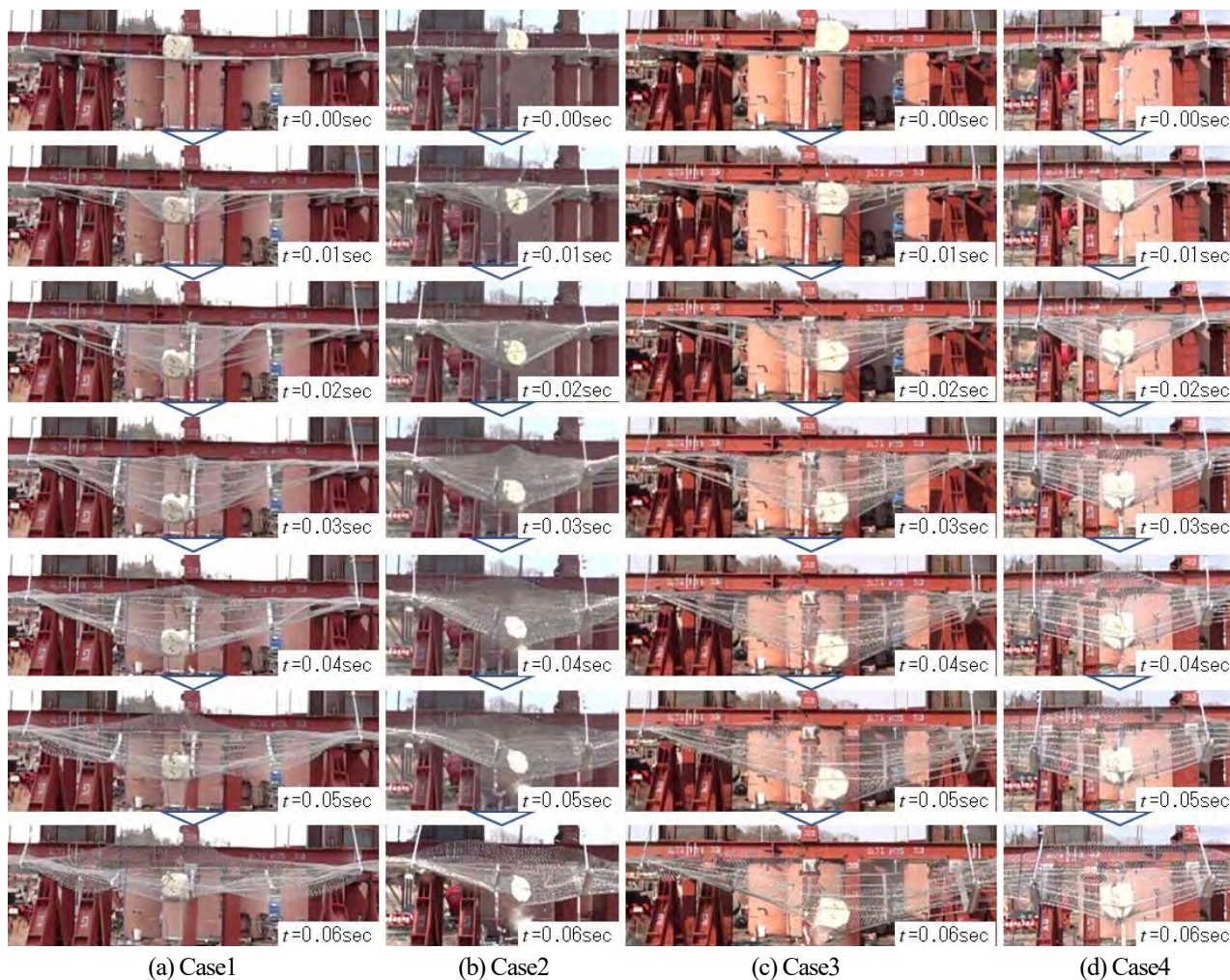
写真-4 重錘衝突後の供試体挙動
