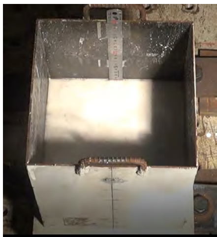
写真-4 ウーブレット供試体
