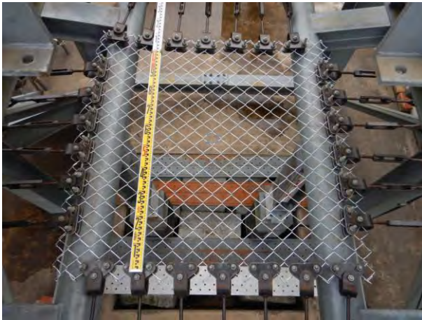
写真-9 金網部材試験装置
