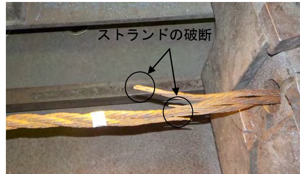
写真-6 試験後の状況 (Case2-5)
