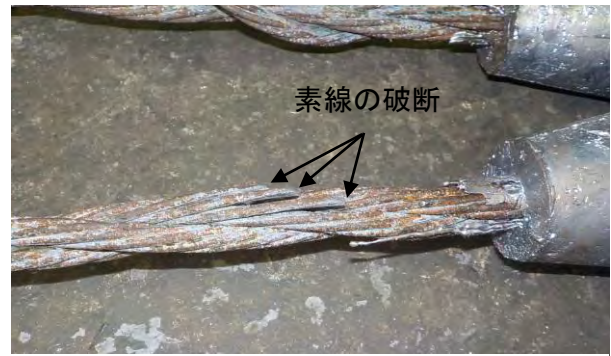
写真-5 試験後の状況 (Case1-3)
