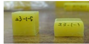
写真-2 圧縮試験後の試験片
