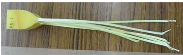
写真-1 引張試験で破断後の試験片
