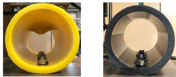
(a) MDPE 管 (b) HDPE 管 写真-4 変形状況の比較 (荷重10kN時)
