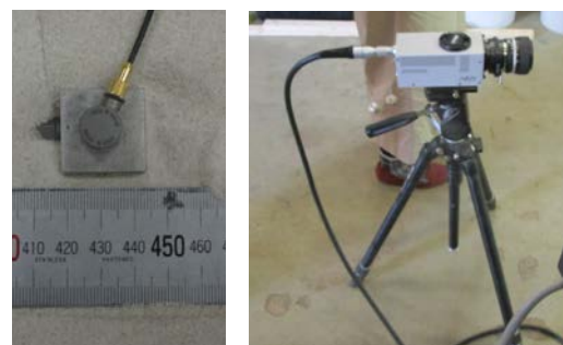
写真一2 加速度計及び高速カメラの設置状況 (左：加速度計，右：高速カメラ)
