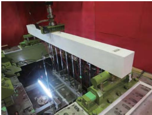
写真-2 静荷重載荷時の実験装置と試験体の設置状況
