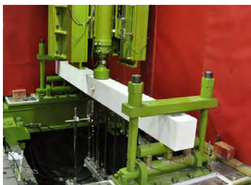
写真－1 衝撃荷重載荷時の実験装置と試験体の設置状況
