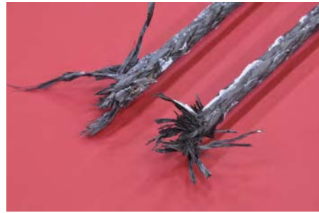
(b) CFRP ロッド破断部の状況
