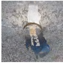
(a) 板厚 12mm, 速度 57.1m/s : 非貫通
