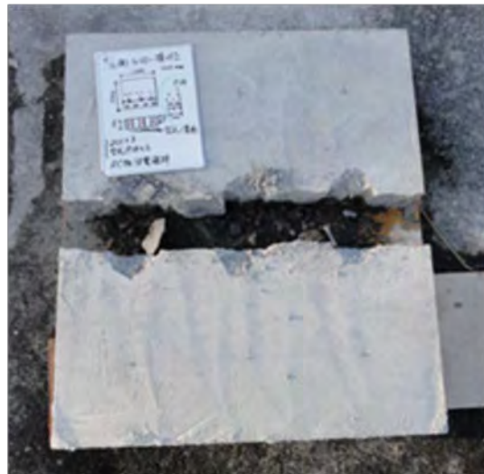
図-10 大型試験体のひび割れ進展方向制御試験後の状況
