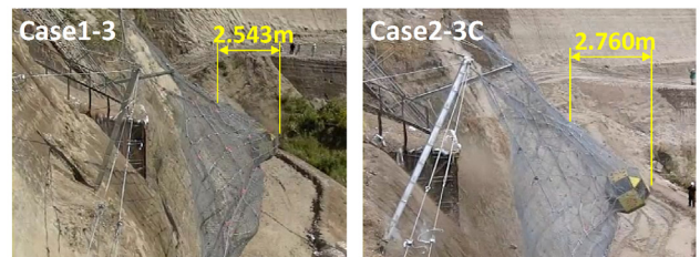
写真-3 金網最大変形量(左: Case1-3, 右: Case2-3C)
