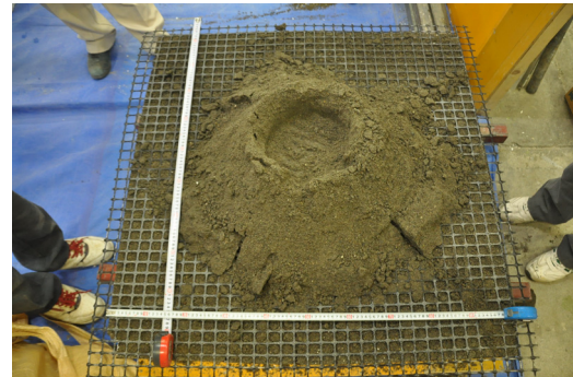
図－11 試験体の破壊状況 ( V = 8.0 \text{ m/s} )
