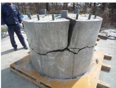
写真 - 23 破砕状況 (直後)
