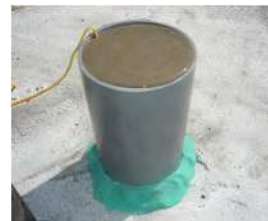
写真 - 12 超速硬モルタル
