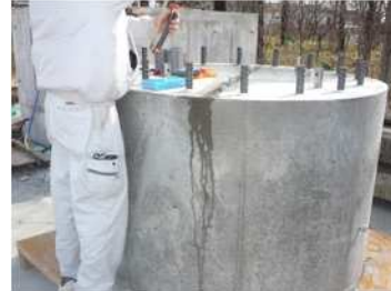
写真 - 8 NRC 装薬 (試験体 1)
