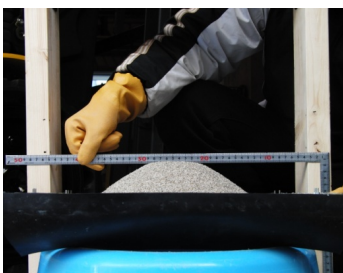
写真 - 1 土砂の垂直落下による安息角確認試験
