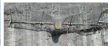
写真-1 落石防護柵実験場および実験状況（落石エネルギー E=3,000kJ）
