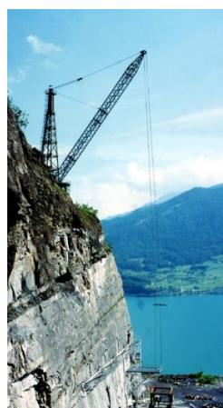
写真-1 落石防護柵実験場および実験状況（落石エネルギー E=3,000kJ）
