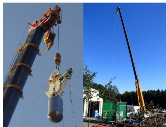
図1 重錘を用いた自由落下衝突試験の概要
