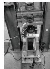
写真-4 重錘落下衝突実験セットアップ
