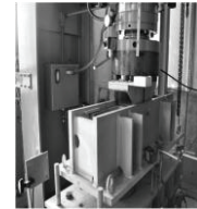
写真-3 静的および急速荷重実験セットアップ
