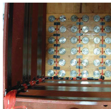
写真-2 土槽底面に配置した土圧計
