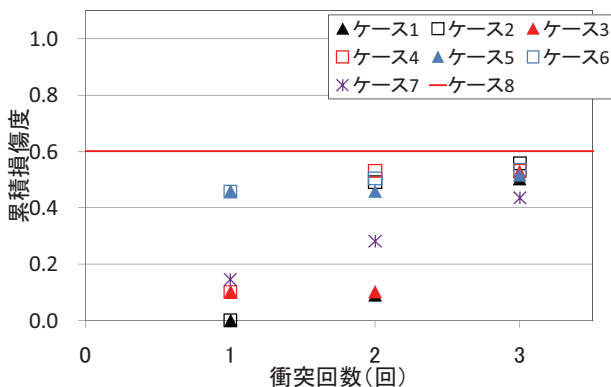
図-6 主鉄筋の最大累積損傷度と衝突回数との関係 (全ケースの比較)
