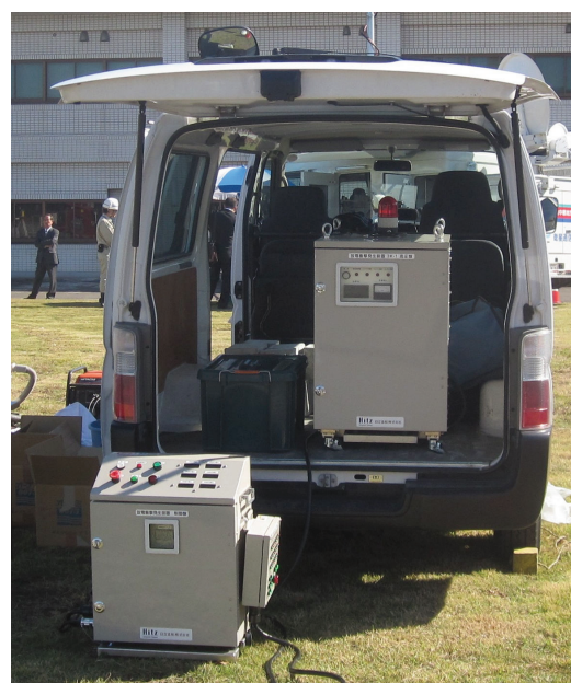
図-2 放電衝撃発生装置
