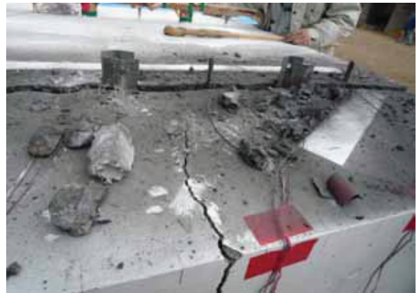
写真一8 RC 試験体の自由面側に生じた亀裂
