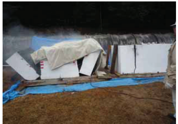
写真一9 破断面制御破砕の再現性
