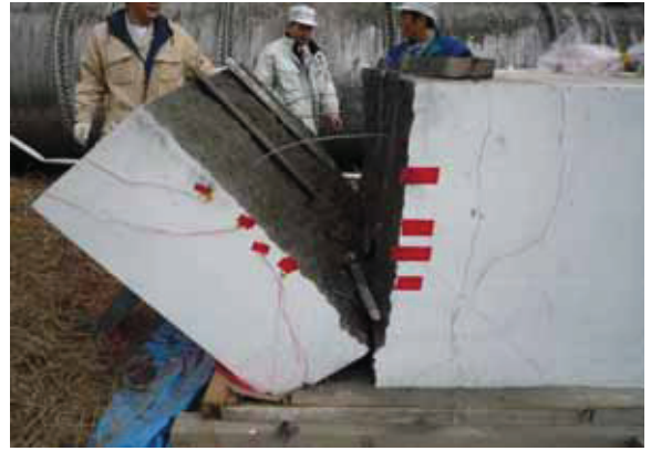
写真一6 無筋コンクリート試験体の破断状態
