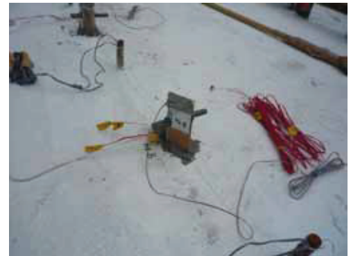
写真-3 コンクリート試験体へ装着された簡易装薬ホルダーとタンピング状態（横ピンはタンピング材の吹き出し防止のため）
