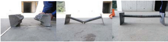
写真-2 コンクリートおよび鉄筋の破壊状況
