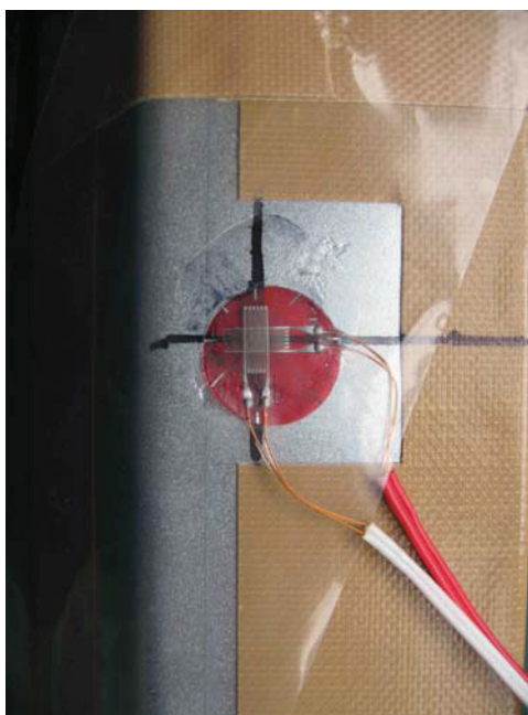
図-3 ひずみゲージ設置状況 (簡易ホルダー表面)
