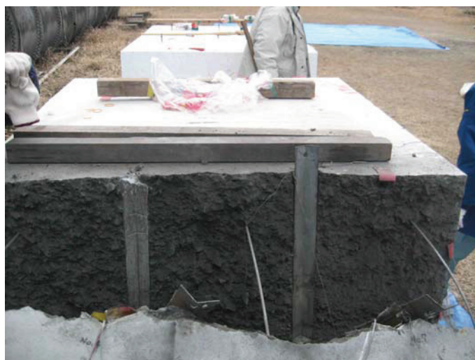
図4 コンクリート供試体の破断状況
