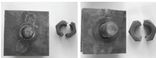
写真-15 M22 及び M30 のナット切断状況
