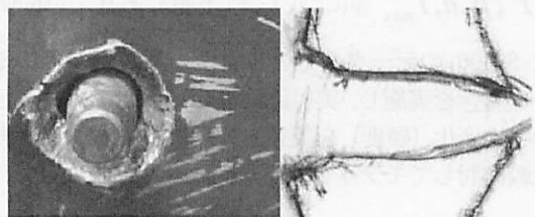
図-8 弾心硬度：HRC50 の時の SHT 表面（写真）と貫通孔形状（切断面）
