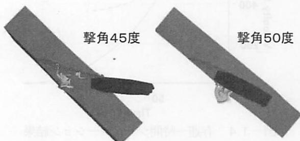
図-16 200 \mu s後の飛翔体の標的への貫徹状況
