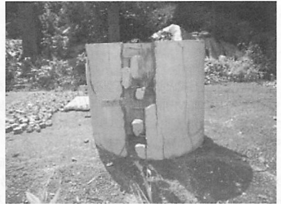
(b) 試験体の損傷状況
